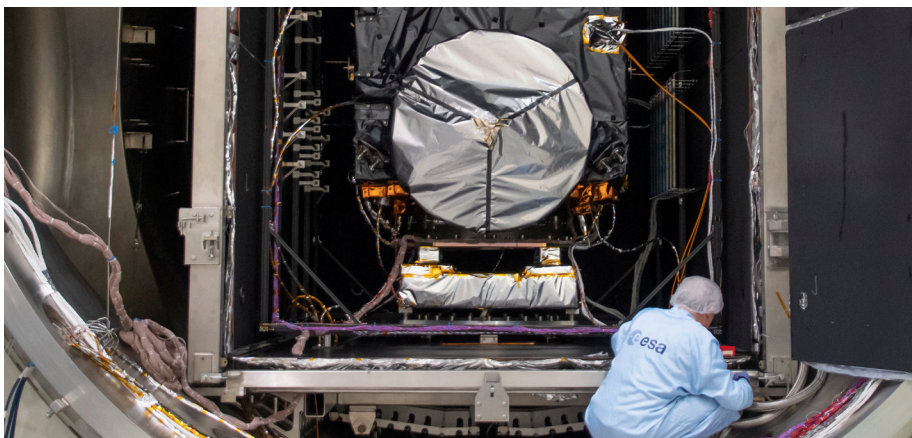
Foto (ESA – A. Conigli): ESAs Hera Mission i et vakuumkammer for at blive testet til rumfart.
