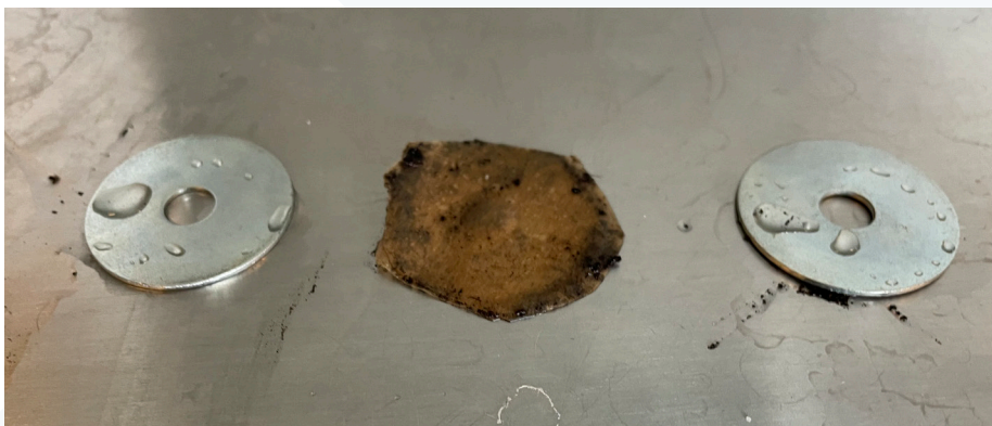
Foto: En spændeskive på hver side af membranen holder styr på den, når den bliver våd og blød.
